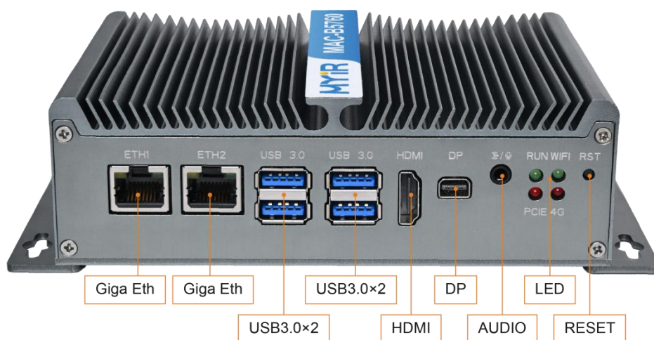
图 2-1 MEC-B5760 AI 边缘工控机正面接口标注图
